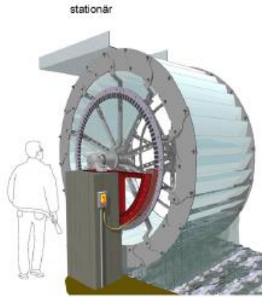
Leistung: ca. 12 kW
